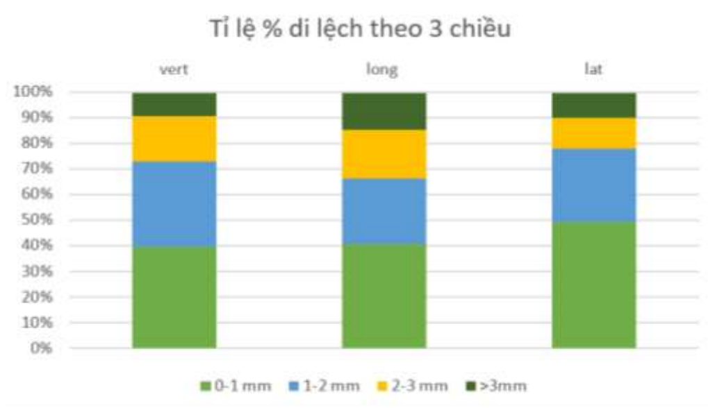
Hình 6. Tỷ lệ % di lệch theo 3 chiều khi đặt bệnh bằng hệ thống OSMS
