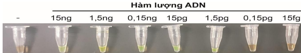
Hình 3.5. Phát hiện sản phẩm LAMP bằng chỉ thị màu Calcein dưới ánh sáng thường.
