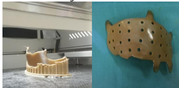
Hình 1. Mảnh ghép PEEK sau khi thiết kế được in bằng máy in 3D
